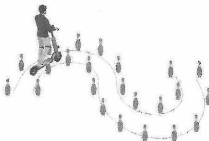
**Препятствие 3 «Кривая дорожка».** Используются фишки диаметром до 7 см и высотой - 12 см. Необходимо не менее 20 фишек, которые устанавливаются, образуя габаритную букву «П». Расстояние между фишками - 70 см, ширина габаритного коридора - 100 см. Длина верхней перекладины, образованной габаритной буквы «П» - 340 см. Расстояние между 1 и 2 фишками верхней перекладины - 70 см, между 2, 3 и 4 – 100 см. Участник проезжает по дорожке из фишек, стараясь их не коснуться.
